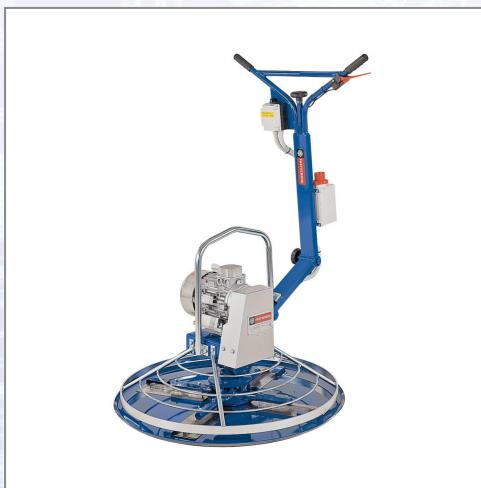
Flügelglätter LEVEL 100 mit 4 Feinbearbeitungsflügel und Schutzbügel. Zusammenlegbarer Führungsarm und Einstellung der Flügelneigung mittels mechanischen Systems. Fliehkraftkupplung, verzinkte Schutzgitter, Totmannschaltung und Schnellverstellung der Führungsdeichsel. Ausführung mit 4-Takt-Benzinmotor oder mit Elektromotor. Tehnički podaci: - promjer: 900 mm, - elektro motor s 2 stupnja brzine: 400 V / 1,8 + 2,6 kW, - težina: 76 kg.
