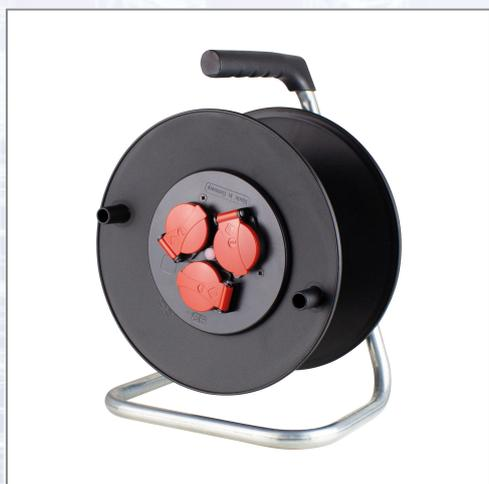
Kunststoff-Leertrommel aus robustem, hochbruchfestem Spezialkunststoff mit stabilem, stoßdämpfendem, verzinktem Einfach-Fußgestell, Feststellbremse, ergonomisch rutschfestem Haltegriff, eingebautem Thermoschutzschalter und 3 Schutzkontaktsteckdosen mit Sicherheitslappdeckeln und Hammerzeichen. IP44: zur Verwendung im Außenbereich.
