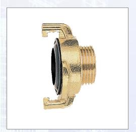
Kupplung aus Messing, mit Mehrzweck-Gummi-Druck- und Saugdichtung. Einheitliche Nockenwelle von 40 mm (Kombination von Schlauch- und Gewindestücken 3/8 " bis 6/4 " untereinander möglich). 10 bar Betriebsdruck, für Wasser und Druckluft.
