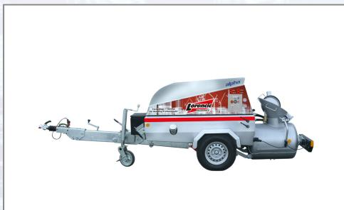
Die ALPHA E63 wurde speziell für den Einsatz auf Baustellen mit konventionellem Baustrom entwickelt. Durch den frequenzgeregelten Drehstrommotor kann sie an alle Baustromverteiler angeschlossen werden. Die Leistung kann vor Ort von 50 A bis 63 A flexibel eingestellt werden. Der frequenzgesteuerte 30 kW Elektromotor verleiht der Estrichpumpe ihre ganze Kraft. Dabei entstehen keine Emissionen (kein CO<sub>2</sub> Ausstoß). Die ALPHA E63 besitzt eine
