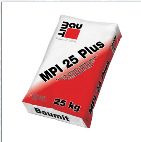
Fertiger Kalk-Zement-Maschinenputz für händische und maschinelle Verarbeitung zum Auftragen auf Wandflächen im Innenbereich. Innenputz mit Gitterstruktur, fertig zum Streichen. Für alle mineralischen Untergründe. Körnung: 1 mm. Potrošnja: cca. 14 kg/m<sup>2</sup>/cm. Izdašnost: cca. 1,7 m<sup>2</sup>/vreća za 1cm
