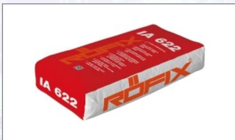
Mineralische, weiße Klebe- und Armierspachtel für weiße Polystyrol-Fassadendämmplatten (EPS-F). Für 3 mm Armierschichtdicke (Nennputzdicke NPD). Ohne Verdübelung ausschließlich für Dämmdicken bis max. 10 cm einsetzbar. Nutzungskategorie: III gemäß ETAG 004. Zum Kleben und Armieren von sägerauhen, trockenen Sockelplatten (EPS-P/XPS-R). Sockeldämmplatten, die mit System-Klebe- und Armierungsmörtel und Oberputz beschichtet wurden, sollen im
