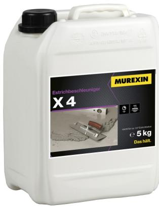
Flüssiges, chloridfreies, universelles, beschleunigend wirkendes Zusatzmittel für zementgebundene Estriche. Durch die verflüssigende Wirkung kann die Wasserzugabe reduziert, und eine schnellere Verlegereife erlangt werden. Weiters wird die Konsistenz des Estrichs positiv beeinflusst, wodurch die Verarbeitung in Bezug auf abziehen und glätten verbessert wird. Zur Erzielung früherer Verlegereife und speziell für Heizesträiche geeignet. Verbrauch: ca. 7,5 kg/m<sup>3</sup> Estrich.
